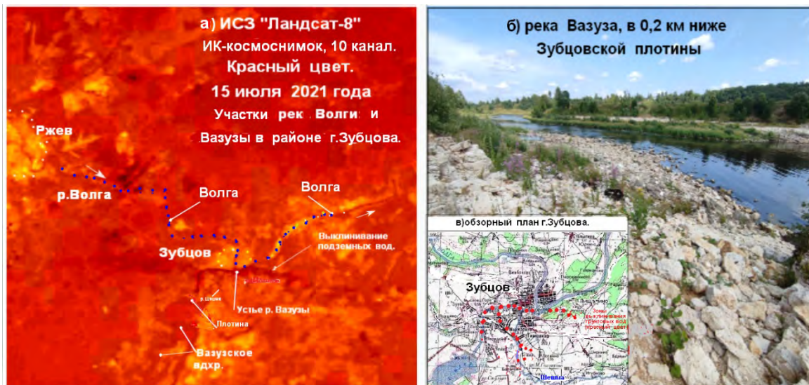
Рис. 15. Выклинивание грунтовых вод ниже плотины Зубцовского гидроузла.
